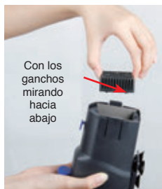
Paso 4. Con los ganchos del Cartucho Cata-Pure mirando hacia abajo, alinee los ganchos con el agujero e inserte el cartucho
