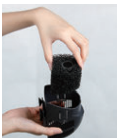
Paso 5. Retire la esponja de filtración del fondo de la unidad del Hydra
